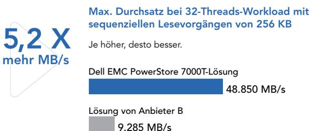
Abbildung 8: Bandbreite (MB/s) während der Ausführung einer Vdbench-Workload mit 256-KB-Datenblöcken. Je höher, desto besser. Quelle: Principled Technologies.
