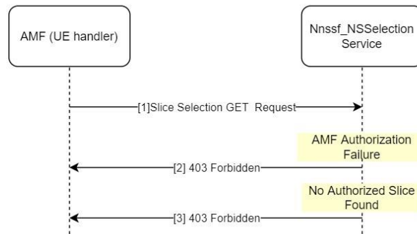
Figure 43. S-NSSAI test call flow
